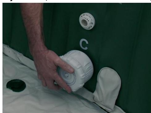
Ako je filter montiran negdje drugdje, voda neće prolaziti kroz filterski uložak koji bi trebao uhvatiti mehaničke nečistoće (dlake i sl.), već će začepiti izlaz pumpe. Nečistoće koje ovako uđu u sustav filtra mogu ga oštetiti – zaglavljivanje pumpe, struganje cijevi pumpe, lomljenje osovine itd. Ove vrste oštećenja nisu pokrivene jamstvom.
