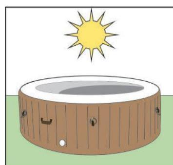
Nakon izlaganja suncu i toplom vremenu, zrak se širi i pritisak raste. Ventil za otpuštanje pritiska omogućava ispuštanje viška zraka.
