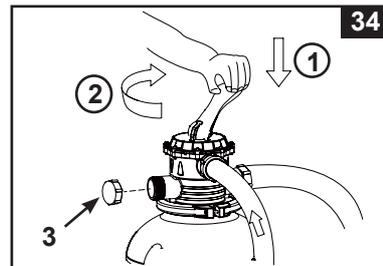
(za više informacija pogledajte odjeljak "Rad sustava u načinu rada s UKLOPNIM SATOM ili u ručnom načinu rada"). Voda cirkulira u nazad kroz pijesak filtra u ispušni/otpadni izlaz. Ispirajte sve dok u izlazu za otpad/ispuš ili kroz prozor ispusta taloga ne vidite da teče čista voda.
