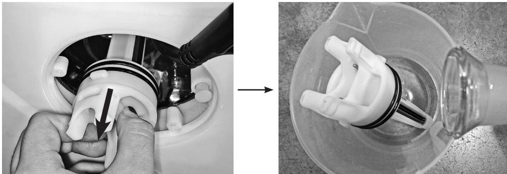
6. Izvadite elektrolitski članak i titansku pločicu isperite svježom vodom. Budite oprezni: utičnicu elektrolitskog članka držite potpuno suhom i nemojte dopustiti da dođe u kontakt s octom i vodom.
