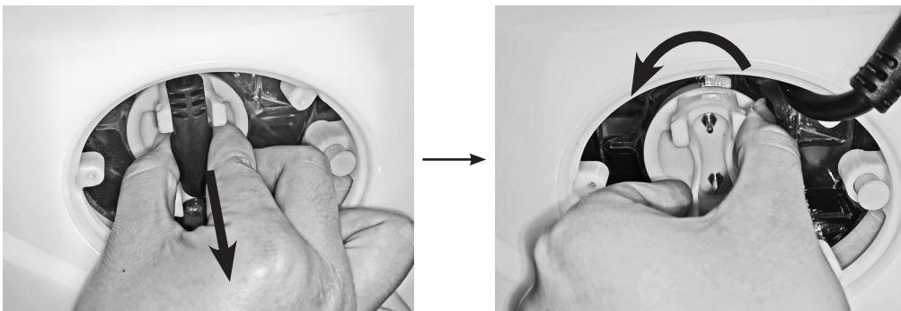
5. Izvucite elektrolitski članak i stavite ga u posudu. U posudu ulijte kuhinjski ocat i držite titansku pločicu uronjenu oko sat vremena dok se ne uklone sve naslage.
