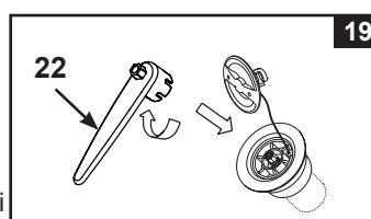
**VAŽNO!** Kućište zračnog ventila nemojte nikada podešavati kada se hidromasažni bazen upotrebljava ili kada je napunjeno vodom. Ključ za zračni ventil upotrijebite samo ako je zračni ventil otpušten ili ako zrak izlazi oko kućišta zračnog ventila. Zračni ventil nemojte previše pritezati jer može se oštetiti uslijed prekomjernog pritezanja. Vodite računa da zračni ventil čvrsto dosjeda i da ne ispušta zrak.
