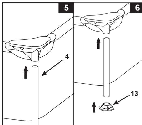
7. Provućite spone učvršćenja ispod korita bazena. Spojite "Y" spoj okomitih nogu (9) na "T" spojeve (7) i učvrstite te spojeve pomoću unaprijed postavljenih opružnih kopči (8). Poravnajte također otvore spona učvršćenja s dnom "Y" spojeva okomitih nogu (9). Postavite završne kapice nogu (13) na donje "Y" spojeva okomitih nogu (9) (pogledajte crteže 7).
