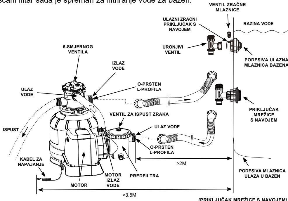
U skladu s međunarodnim standardom, IEC 60364-7-702, u svezi električkih instalacija bazena i druge opreme, moraju se poštivati slijedeće udaljenosti ugradnje:
