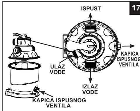
**VAŽNO:** Na 6-smjernom ventilu, nalaze se tri priključka za crijevo. Pazite da izlazni priključak (od filtra u bazen) na ventilu bude okrenut prema bazenu (pogledajte crtež 18).
