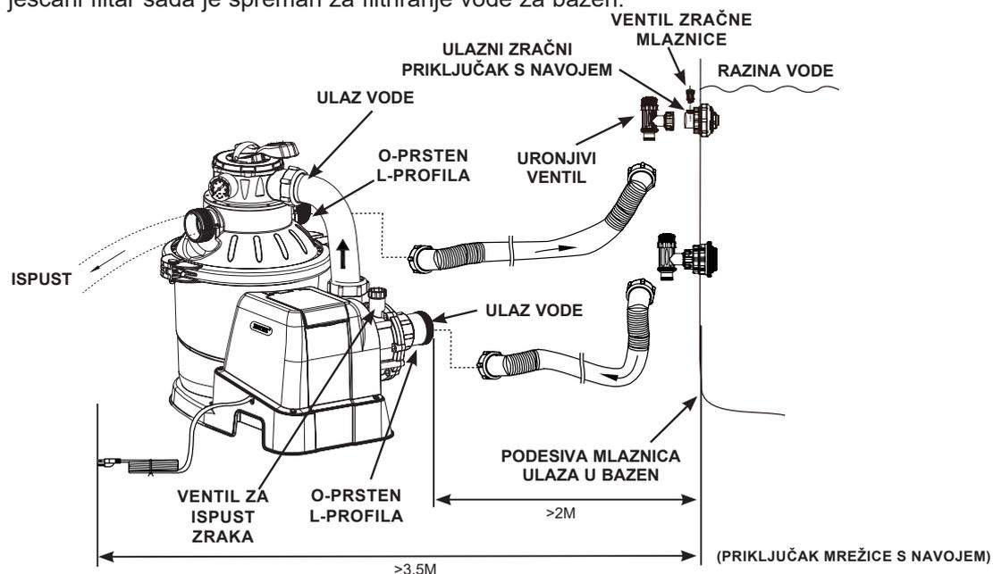
U skladu s međunarodnim standardom, IEC 60364-7-702, u svezi električkih instalacija bazena i druge opreme, moraju se poštivati slijedeće udaljenosti ugradnje:
