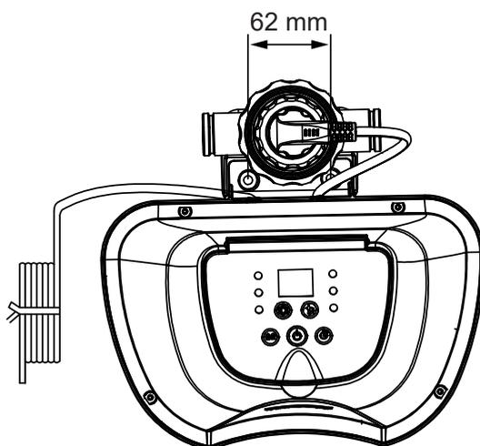
1. Promjer montažni provrta je 6,4 mm, a međusobna udaljenost 62 mm.
