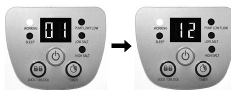
odabrali previše sati,
