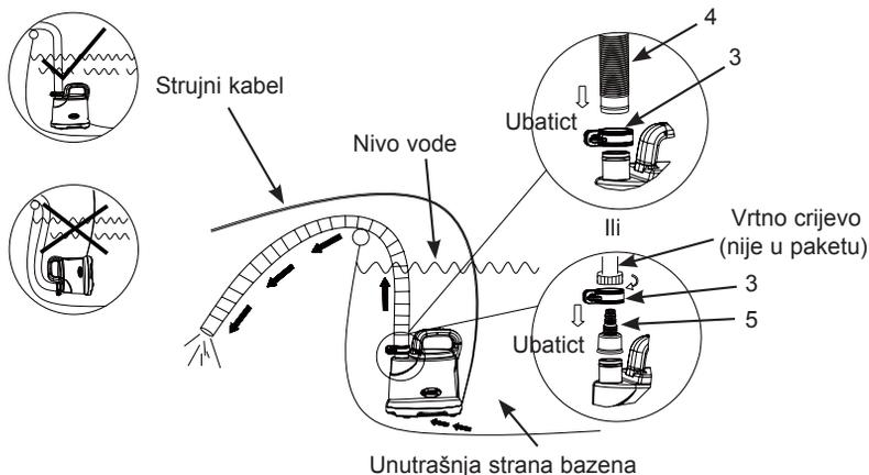
**NAPOMENA:** Maksimalna dubina bazena ne smije biti veća od 1,22 m (48 inča). Da biste zaštitili motor crpke od rada na suho, odspojite kabel napajanja od električne utičnice nakon ispuštanja vode ili kada je preostala voda ispod razine postolja crpke za pražnjenje.
