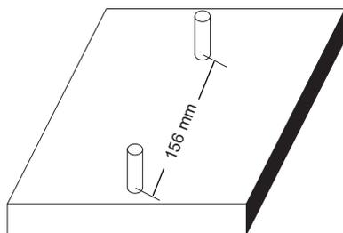
1. Promjer rupica za montiranje iznosi 6,4 mm. Razmak između rupica iznosi 156 mm.
