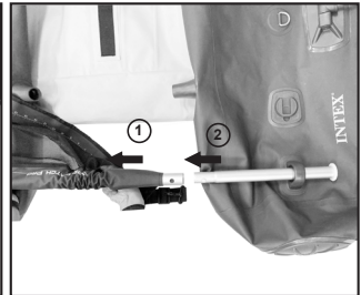
5. Utaknite kratku "dvodijelnu montažnu cijev" kroz otvor za montažu trupa na drugoj strani i u dugačku montažnu cijev. Provjerite je li opružni gumb fiksiran na mjestu.
